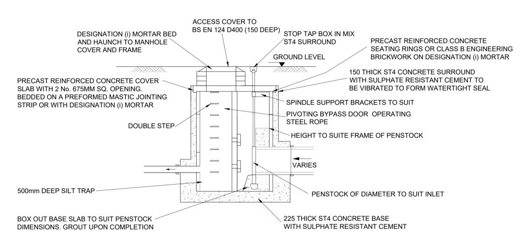
TYPICAL SECTION C-C TYPICAL HYDROBRAKE MANHOLE Scale 1:50
